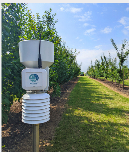
Station météo mesurant pluviométrie, température et hygrométrie (Weenat)
