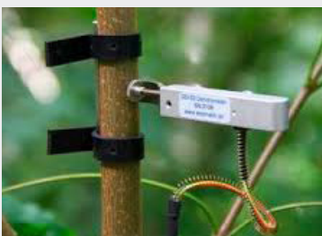
Dendromètre (Ecomatik) (source : AgriExpo)
